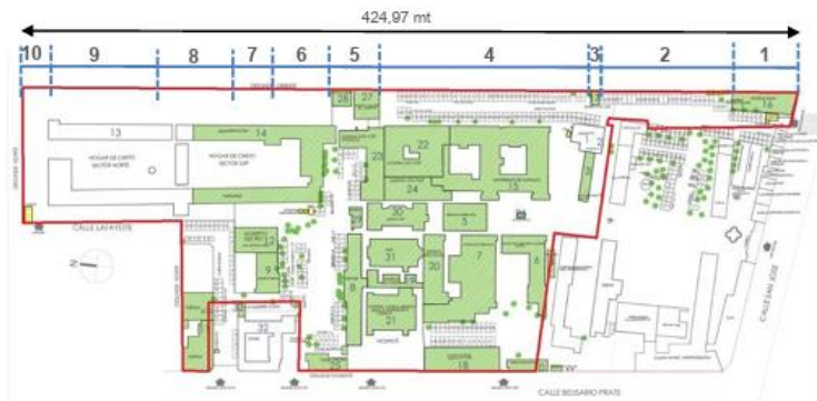
Figura 1. Subdivisión de tramos muro colindante con cementerio General de acuerdo con estudio estructural.
